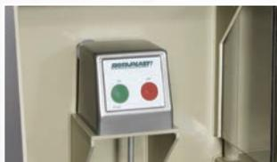
Lorsque le niveau d'eau usée dans l'évier a atteint son niveau maximal, elle doit être purifiée avant le prochain processus de nettoyage. Lancer le mélangeur en appuyant sur le bouton vert de l'appareil. Le minuteur intégré arrête automatiquement le mélangeur après 15 minutes.
