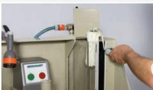
Placer le rouleau dans le « nettoyeur de rouleaux » derrière la protection anti-éclaboussures, tenir la poignée du rouleau et déclencher l'alimentation d'eau.
