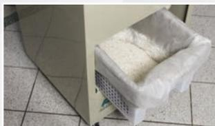
Les boues restent dans le filtre, l'eau retourne dans le conteneur d'eau claire. La boue filtrée doit être évacuée en tant que matière sèche en observant les réglementations locales et environnementales.
