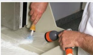
Le nettoyage des brosses ou autres outils se fait avec le pistolet Gardena. Le processus de nettoyage peut être suivi jusqu'à ce que l'évier soit entièrement rempli d'eau usée.
